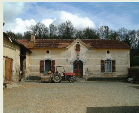
La lucarne-fronton est percée d'une petite baie, trop petite pour que l'on puisse lui attacher un rôle fonctionnel, tout au plus permet-elle de dispenser une faible lueur dans le comble. Sa vocation est essentiellement ornementale.
