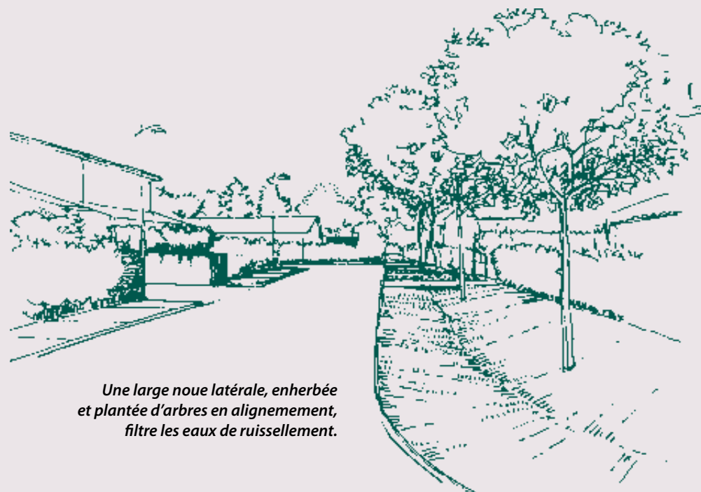
En cœur d'îlot, des jardins structurés par des grandes noues enherbées canalisent les eaux pluviales. ZAC de la Morinais à Saint-Jacques de la Lande (35)
