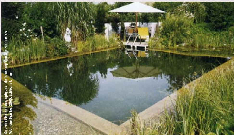
Cette piscine écologique est constituée d'une zone plantée de moins d'1 m. de profondeur, autour d'un bassin de nage. Les plantes aquatiques créent progressivement un biotope qui assure la filtration et l'épuration de l'eau.
