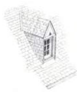
Lucarne en bâtière « jacobine ».
