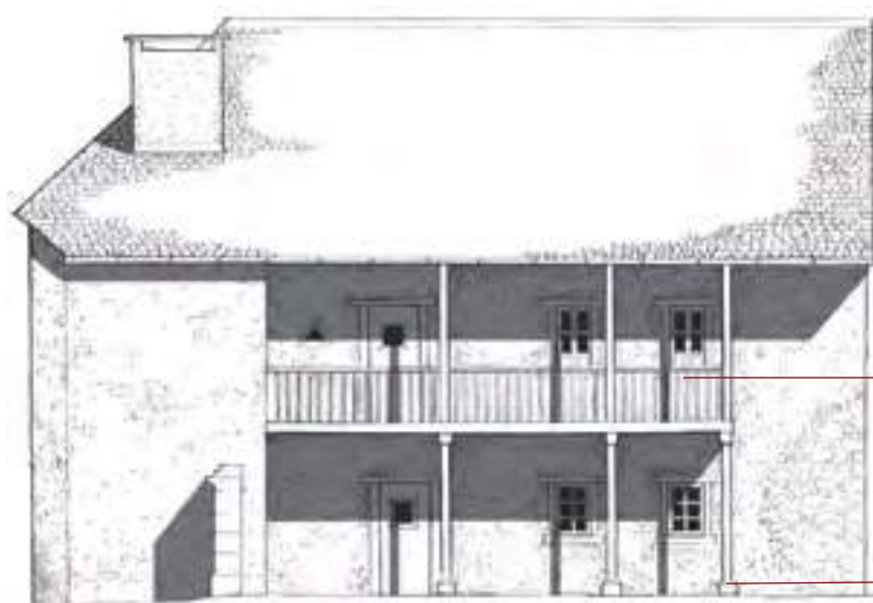
Galerie sur poteaux bois reposant sur des socles en pierre pour éviter la pénétration de l'humidité
