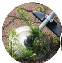
Débroussailluse à disques
