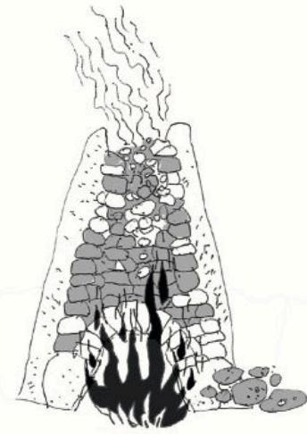
**La chaux aérienne** (ou chaux grasse) est obtenue à partir de la calcination puis du trempage d'un calcaire relativement pur. Elle durcit lentement au contact de l'air et peut être conservée dans l'eau. Elle a l'avantage de sa souplesse, de sa blancheur qui permet d'utiliser des **pigments** pour des effets décoratifs.
